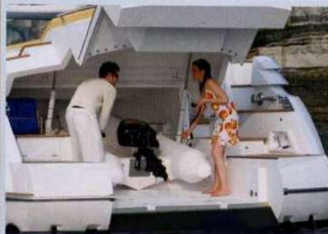
Sopra, il garage può ospitare un tender o una moto d'acqua a due posti. A pagliolo l'ispezione dei timoni. Sotto, i passavanti.
