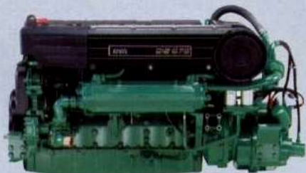
Il C52 monta i nuovi Volvo Penta D12 da 675 cv, accoppiati a linea d'asse.
