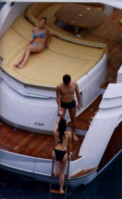
A fianco, tutta la cuscineria esterna è realizzata in schiuma monocellulare a cellula chiusa, praticamente impermeabile.
